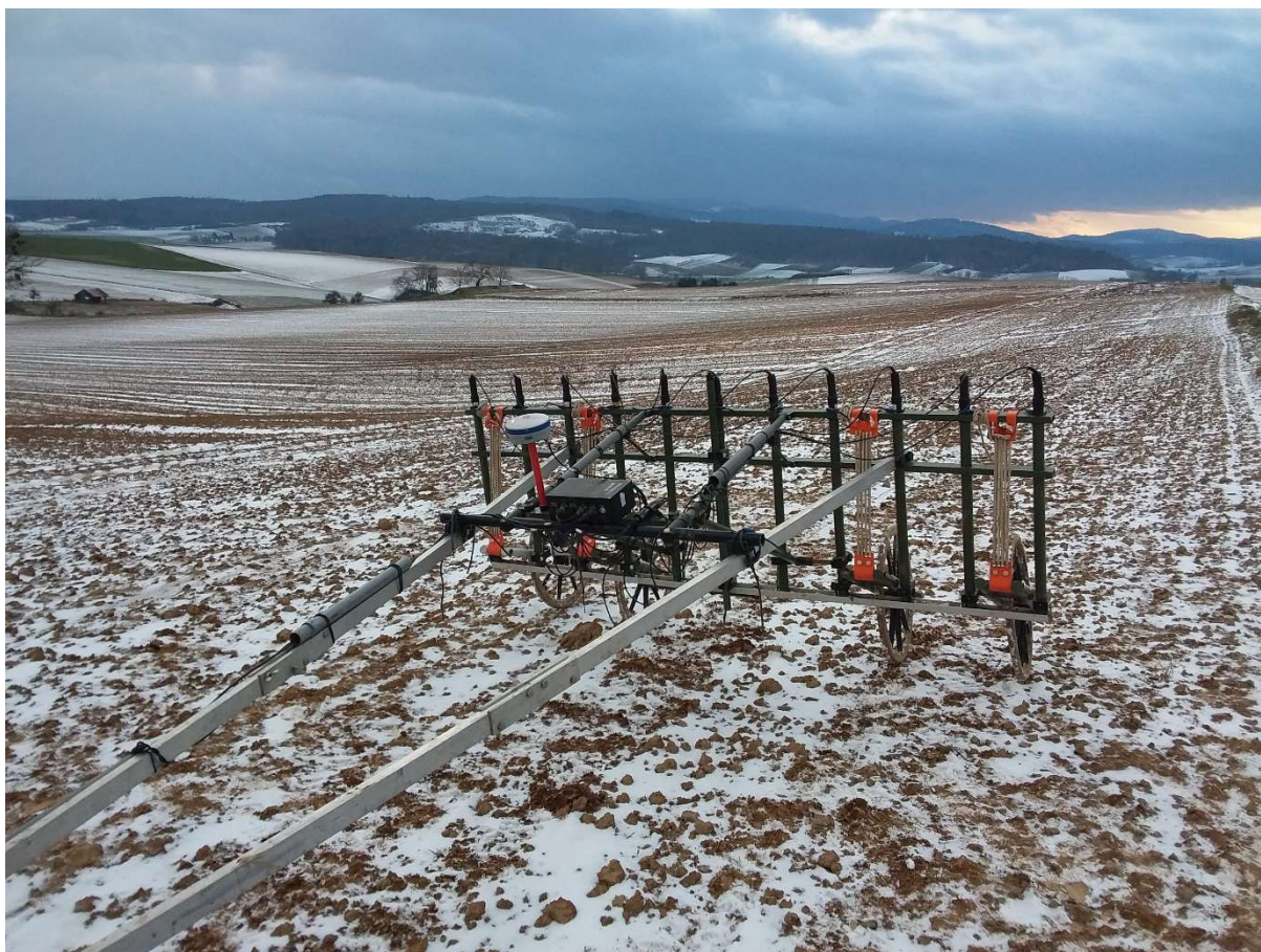
Abb. 3: Übersichtsfoto Sondenarray hinter ATV-Zugfahrzeug (Quelle: Geophysik Consultancy)
